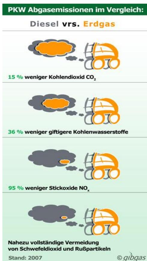
Beim Betrieb von Erdgasautos können die Stickstoff-, Kohlendioxid-, Kohlenmonoxid-, Kohlenwasserstoff- und Rußwerte deutlich gesenkt werden, da Erdgasmotoren unter allen Verbrennungsmotoren die niedrigsten Abgasemissionen haben. Im Vergleich zum Benzin- und Dieselfahrzeugen
