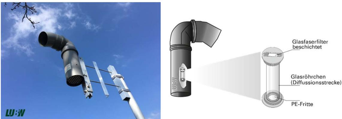
Abbildung A2-2: Passivsammler mit Wetterschutzgehäuse, © LUBW 2016
