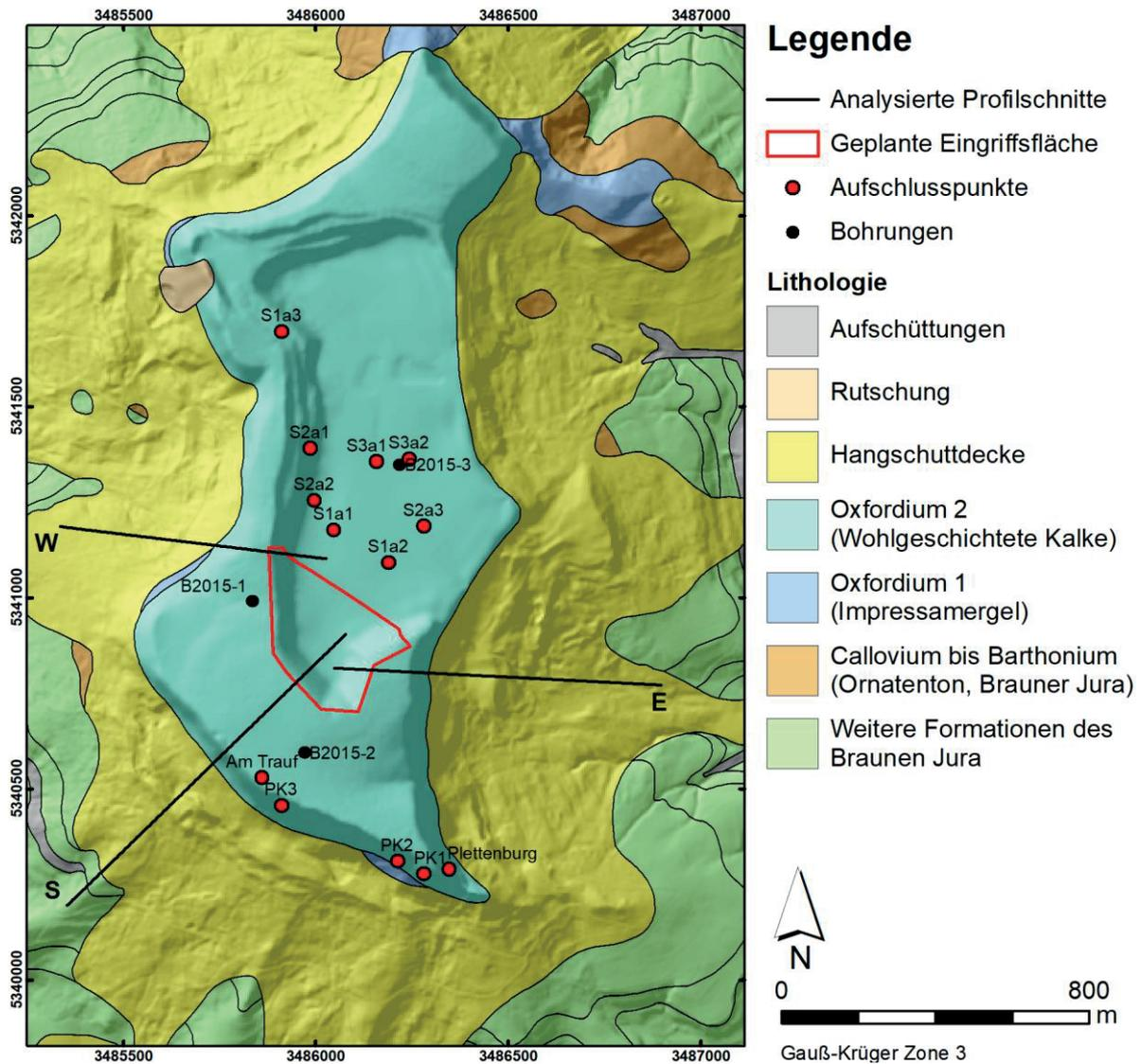
**Abb. 5-1: Übersichtskarte des Plettenberges mit Standorten der berücksichtigten Bohrungen, kartierten Aufschlüssen und Fotoaufnahmen, auf Standsicherheit analysierte Böschungsprofile und Grenzen des bestehenden und beantragten Abbauvolumens.**
