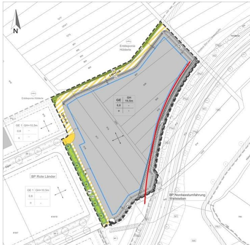
Abbildung 5: möglicher Entwässerungsverlauf Rohrleitungssystem (rote Linie)
